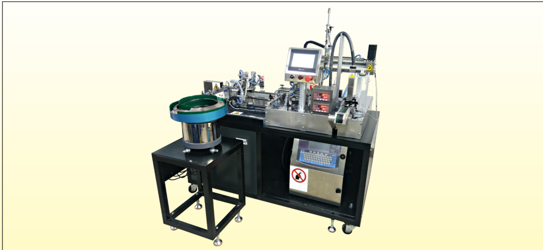
Automatisierte Prüfung der Löttestung in der Produktion bei Umgebungstemperatur
